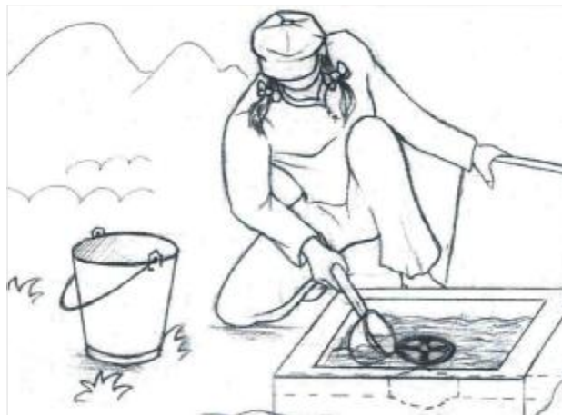
Hình 13: Bảo dưỡng hố van, nạo vét bùn đất.
